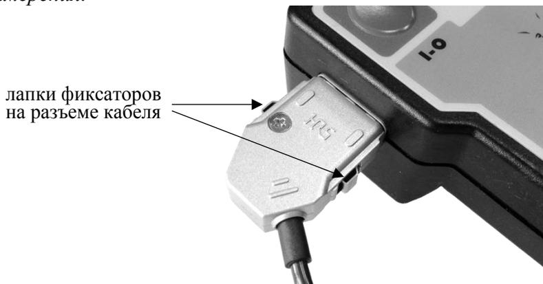
Рисунок 5 – Подключение кабеля связи к анализатору
