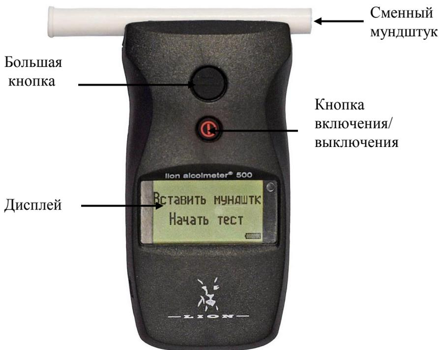
**Рисунок 1.** Анализатор Lion Alcolmeter 500.
